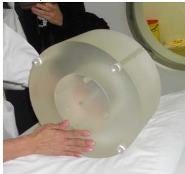
ภาพที่ 2 PMMA phantom ศีรษะและลำตัว (หุ่นจำลองศีรษะอยู่ภายใน - ถอดแยกได้)
