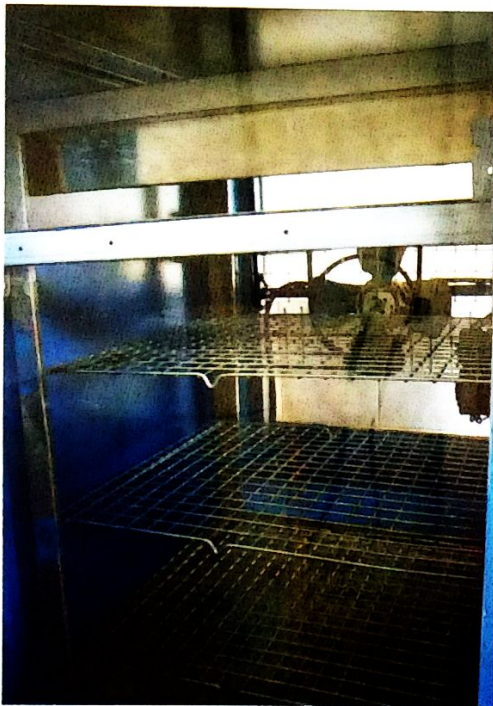
รูปที่ ๓ ตะแกรงสำหรับวางเครื่องมือที่จะนำมาอบแห้ง
