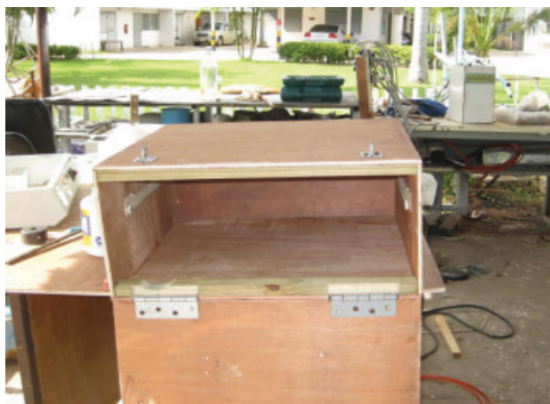
รูปที่ 3 กล่องใส่แผงวงจรและกล่องใส่กล่องแผงวงจรเครื่องกรอฟันที่จัดทำใหม่
