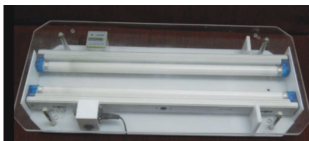
รูปที่ 1 เครื่องส่องไฟรักษาภาวะตัวเหลืองในทารกแรกเกิด ใช้หลอดฟลูออเรสเซนต์สีฟ้า 2 หลอดที่ใช้ในการทดสอบ
