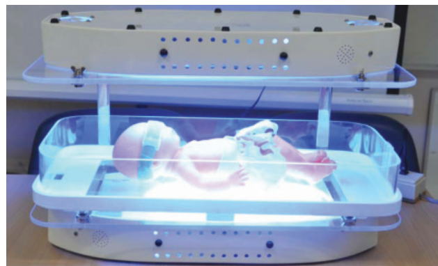
รูปที่ 4 การพัฒนาเครื่องส่องไฟรักษาภาวะตัวเหลืองในทารกแรกเกิดขนาดเล็ก มาประกอบเข้าเป็น double phototherapy
