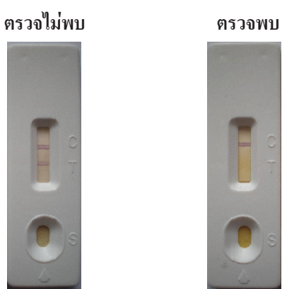
รูปที่ 4 การอ่านผลการทดสอบเดกซ์ซามธาโซนและเพรีดนิโซโลนในผลิตภัณฑ์สมุนไพรด้วยเทคนิคอิมมูโนโครมาโทกราฟี
