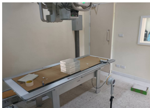
ภาพที่ 1 วางเครื่องมือวัดปริมาณรังสีกระเจิงยี่ห้อ Ray safe รุ่น 452 และหุ่นจำลอง(Phantom) แทนร่างกายสำหรับวัดปริมาณรังสีกระเจิงของเครื่องเอกซเรย์วินิจฉัยทั่วไป
