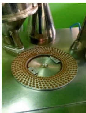
ภาพที่ 3 การนำผงแกรนูลเปียกบรรจุแคปซูล และยาเส้นที่ข้าวสุกแคปซูล 500 มิลลิกรัม
