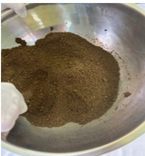
ภาพที่ 2 การทำแกรนูลเปียก (wet granulation)
