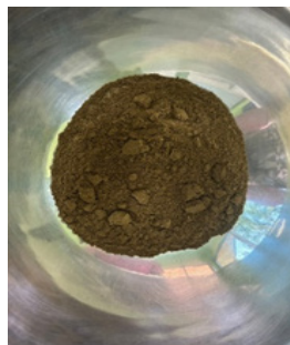
ภาพที่ 2 การทำแกรนูลเปียก (wet granulation)
