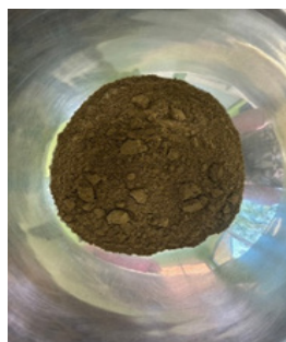
ภาพที่ 2 การทำแกรนูลเปียก (wet granulation)
