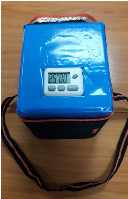
ภาพที่ 4 การติดตั้งที่วัดอุณหภูมิ
