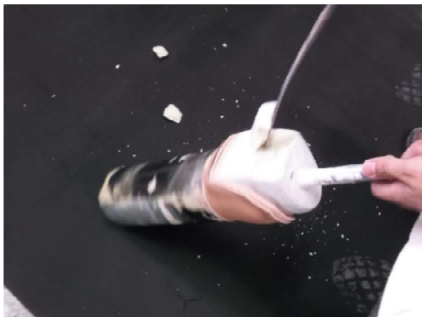
ภาพที่ 3 การแกะเบ้าอ่อนออกจากหุ่นตอขาและขยะจากการทำลายหุ่น (วิธีการเดิม)
