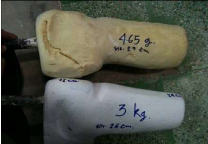
ภาพที่ 2 หุ่นตอขาชนิดนวัตกรรม (ชั้นบน) และหุ่นตอขาวิธีการเดิม (ชั้นล่าง) เปรียบเทียบน้ำหนัก
