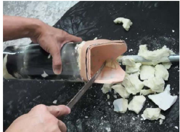
ภาพที่ 3 การแกะเบ้าอ่อนออกจากหุ่นตอขาและขยะจากการทำลายหุ่น (วิธีการเดิม)
