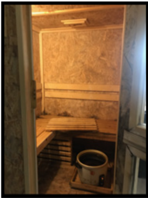
ภาพที่ 1 ตู้อบไอน้ำ ใช้น้ำเดือดประมาณ 80-90 องศาเซลเซียส โดยสามารถปรับอุณหภูมิตู้อบได้ระหว่าง 42-45 องศาเซลเซียส
