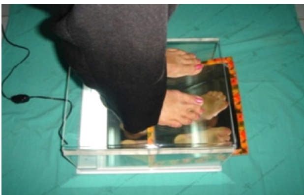
รูปที่ 3 เครื่อง Podoscope พัฒนาเป็นรูปแบบที่ 2
