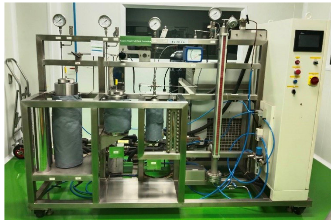
รูปที่ 2 เครื่องสกัด supercritical fluid extraction ขนาดบรรจุ 5 ลิตร
