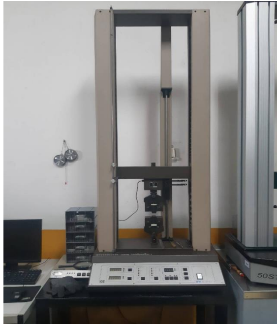
รูปภาพที่ 1 เครื่องวัดแรงดึง (Tensile) เป็นไปตามลักษณะของการทดสอบแบบดึงยึดชิ้นงาน
