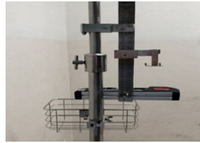
รูปที่ 6 แสดงเครื่องมือตั้งระดับจุดหยดน้ำไขสันหลังนวัตกรรม Version 2 ด้านหน้าและด้านหลัง
