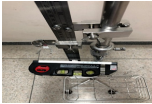
รูปที่ 6 แสดงเครื่องมือตั้งระดับจุดหยดน้ำไขสันหลังนวัตกรรม Version 2 ด้านหน้าและด้านหลัง
